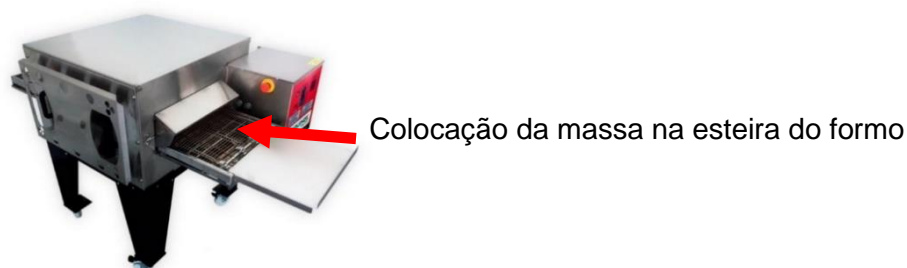
Figura 14: Forno industrial usado pela empresa
