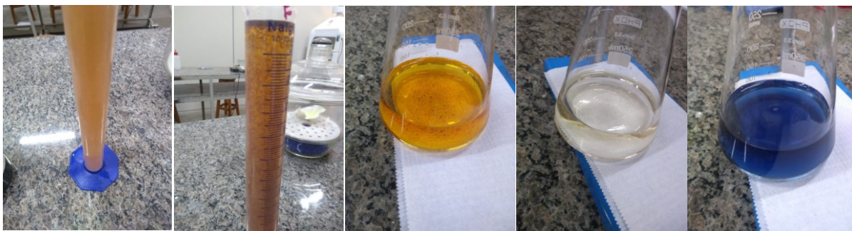
Figura 2: Imagens do sistema após algumas etapas durante a determinação de oxigênio dissolvido.
