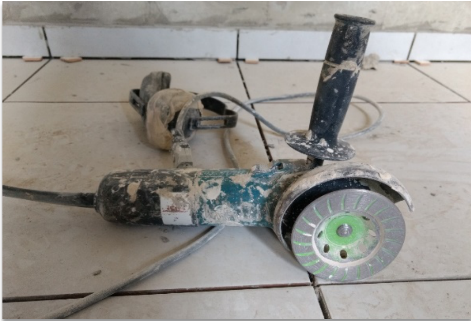
Figura 12:Exemplo de equipamento para limpeza: esmerilhadeira elétrica. Fonte: arquivo do autor
