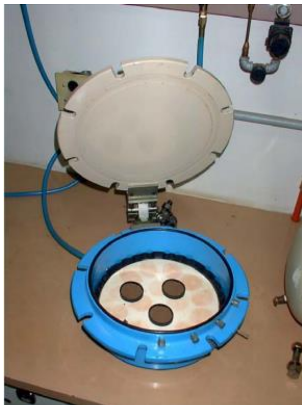
FIGURA 3.4 – Câmara de Richard aberta com a placa cerâmica e algumas amostras de solo sobre ela (Custódio, 2009).
