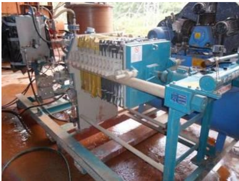
FIGURA 3.1 – Filtro prensa piloto da Diemme utilizado no desaguamento do resíduo estudado.
