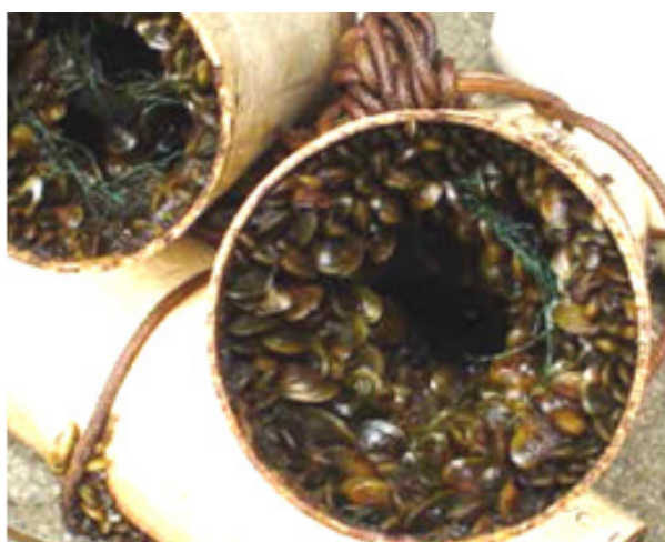
Figura 3.24 – L. fortunei incrustado no interior de tubulações
