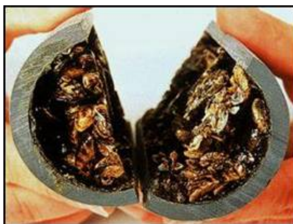
Figura 3.16 – Mexilhões em sistemas de água bruta – sistema de abastecimento de água
