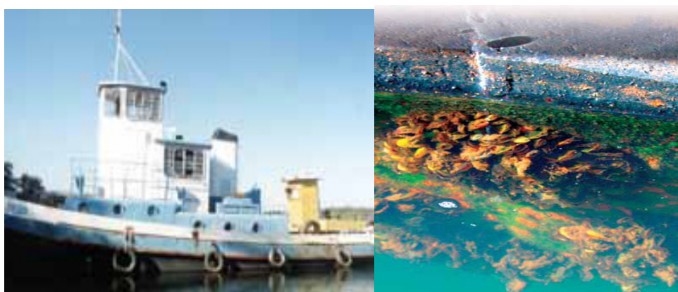
Figura 3.28 – Embarcação e o detalhe do casco com mexilhões aderidos
