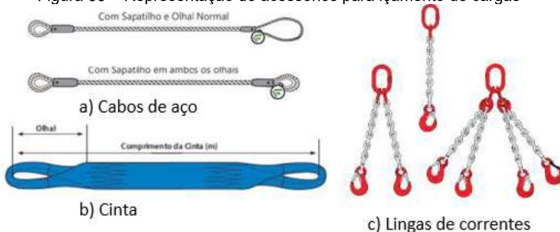
Figura 66 – Representação de acessórios para içamento de cargas
