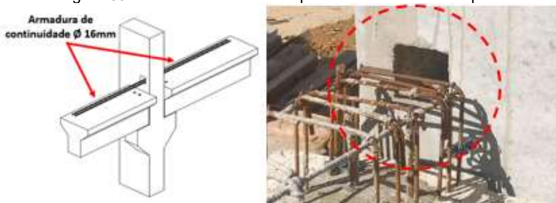
Figura 89 – Detalhe de armadura passante em bainha no pilar
