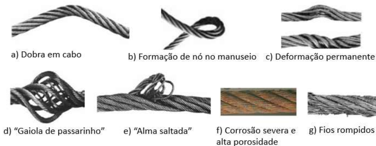
Figura 67 – Indicadores para substituição de cabos de aço
