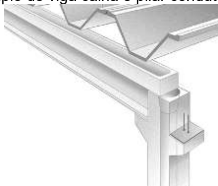
Figura 7 – Exemplo de viga calha e pilar condutor de água pluvial
