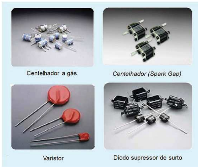
Figura 7.5 – Exemplos de componentes de proteção utilizados nos DPS.
