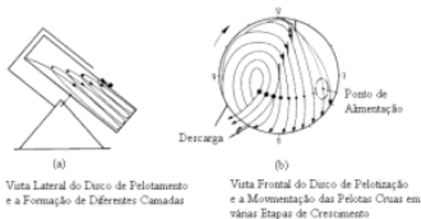
Figura 2.7 – Formação de pelotas cruas em um disco de pelotização (MEYER, 1980).
