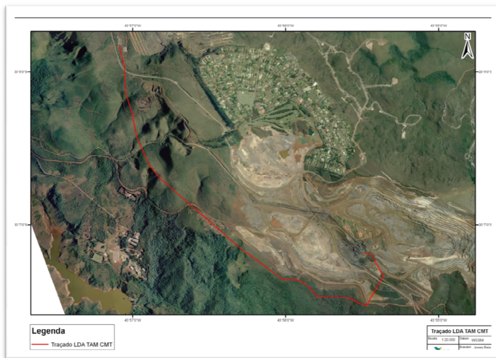
Figura 4.1 – Traçado da linha de 34,5kV (fonte: Vale)
