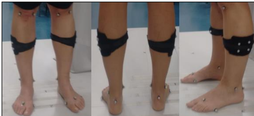
Figura 30 — Protocolo de colocação de marcadores passivos reflexivos na situação estática e dinâmica, definindo os segmentos perna e pé. Fonte: Autor.
