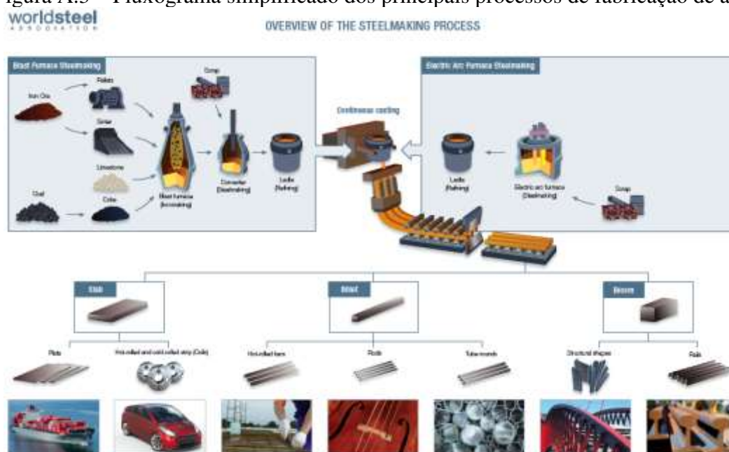
Figura A.3 – Fluxograma simplificado dos principais processos de fabricação de aço.
