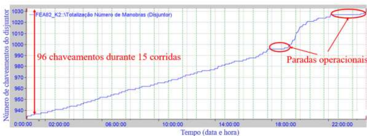
Figura 3.2 – Gráfico de chaveamentos de disjuntor em um dia de operação de usina com dois carregamentos de sucata.
