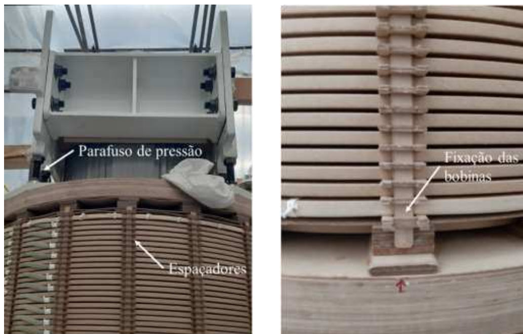
Figura 2.16 – Imagem das bobinas ilustrando as estratégias empregadas para suportar (a) forças axiais (b) forças radiais.
