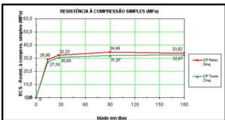
Figura 34 – Valores e curvas comparativos de resistência à compressão simples de concretos – referência sem rejeito e teste com rejeito – CP IV 40 RS, a/c 0,63
