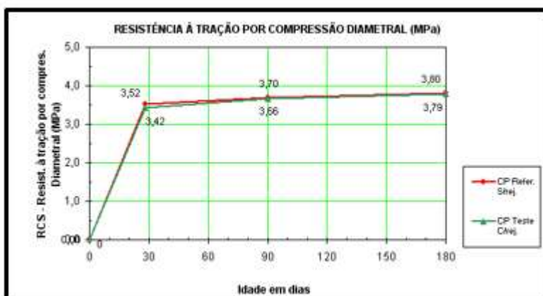
Figura 37 – Valores e curvas comparativos de resistência à tração por compressão diametral de concretos – referência sem rejeito e teste com rejeito – CP IV 40 RS, a/c 0,63
