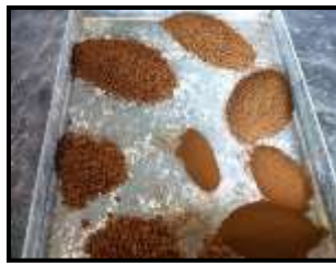
Figura 11 – Imagem da granulometria do rejeito para estabelecimento do percentual das respectivas frações
