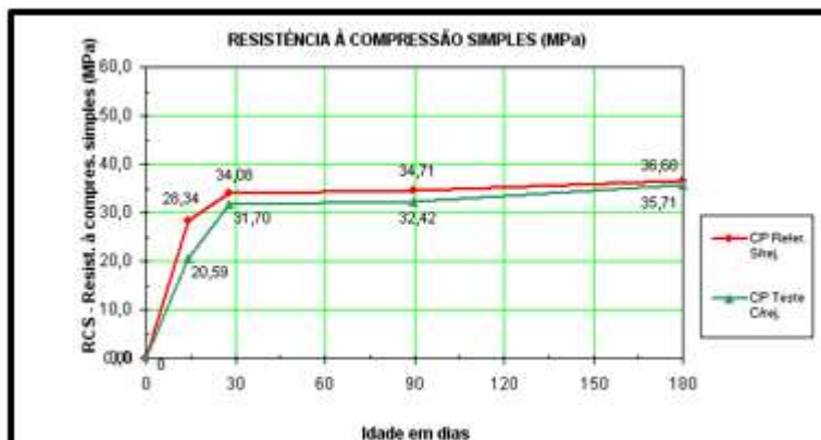
Figura 33 – Valores e curvas comparativos de resistência à compressão simples de concretos – referência sem rejeito e teste com rejeito – CP II E – 32, a/c 0,63
