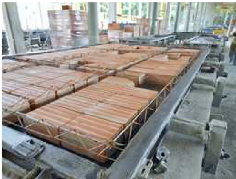
Figura 57- Detalhe dos blocos cerâmicos entre as armaduras
