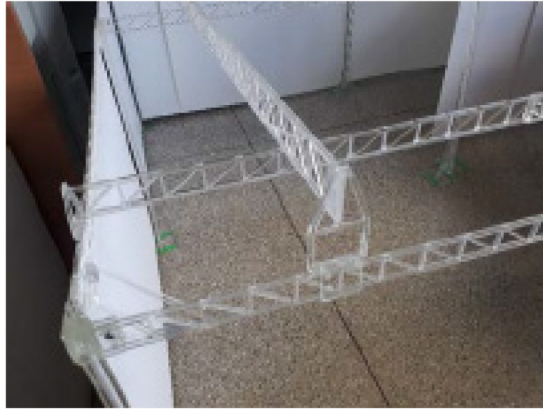
Figura 20 - Modelo na escala 1:4 em acrílico simulando três módulos e vedações
