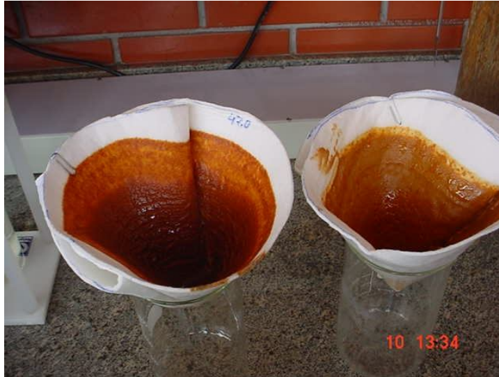
Figura 5.11 – Filtro com lodo após a filtragem do efluente
