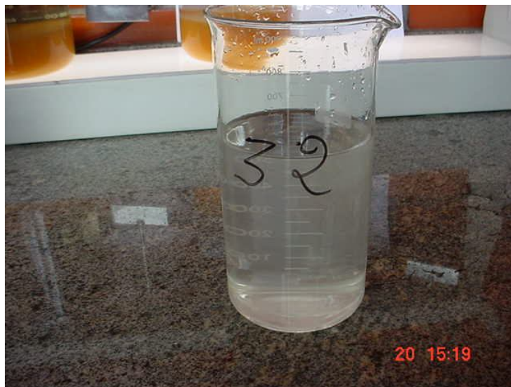
Figura 5.12 – Efluente final tratado
