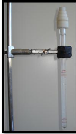
Figura 10: Viscosímetro de queda de bola utilizado na determinação da viscosidade.
