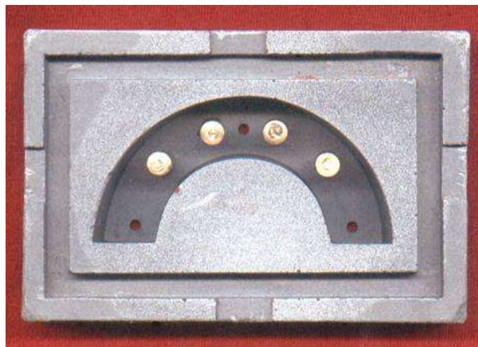
Figura 6 – Base da matriz para confecção das barras. Cilindros de latão fixados no fundo da cavidade.
