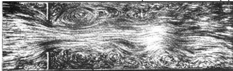
Figura 4 - Foto de um dispositivo experimental para analisar o escoamento do fluido por uma placa de orifício. Fonte: Delméé 1999
