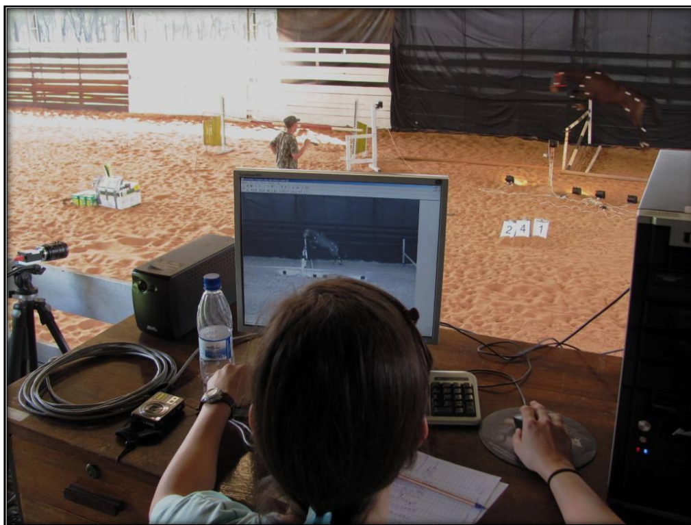
Figura 29. Aparato de filmagem: câmera Basler A602fc ® e o aplicativo Simi Reality Motion Systems ®
