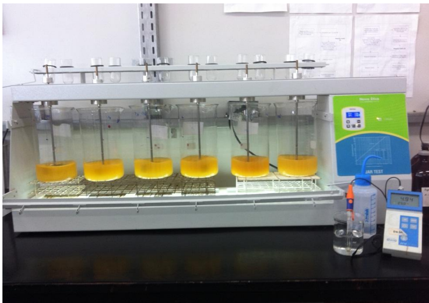
Figura 4.1 – Foto dos ensaios Fenton Homogêneo
