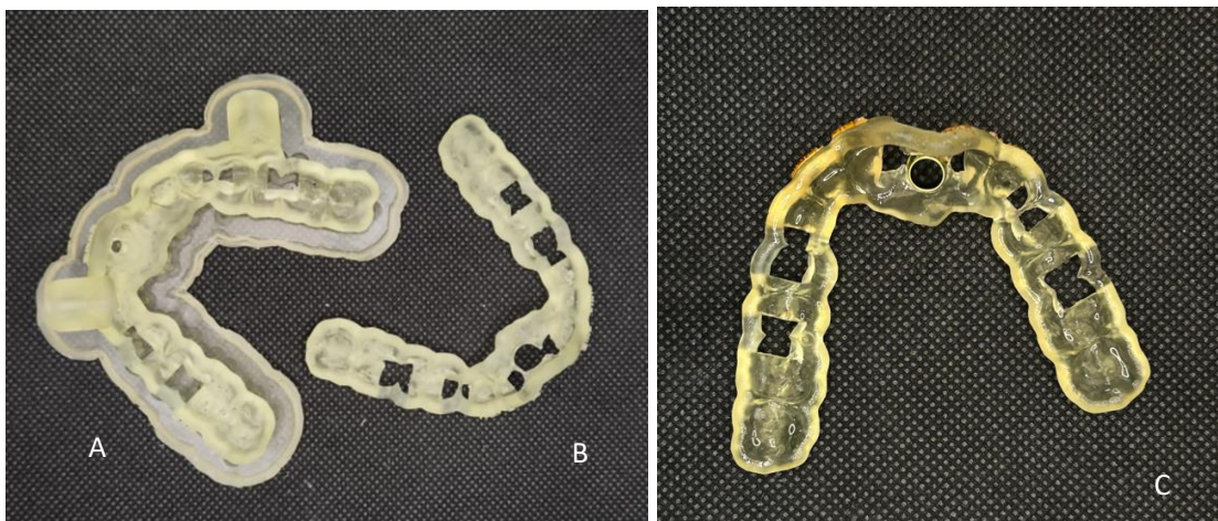
Figura 26: Guia com suporte (A), guia sem suporte (B), guia após o polimento e com a anilha (C).
