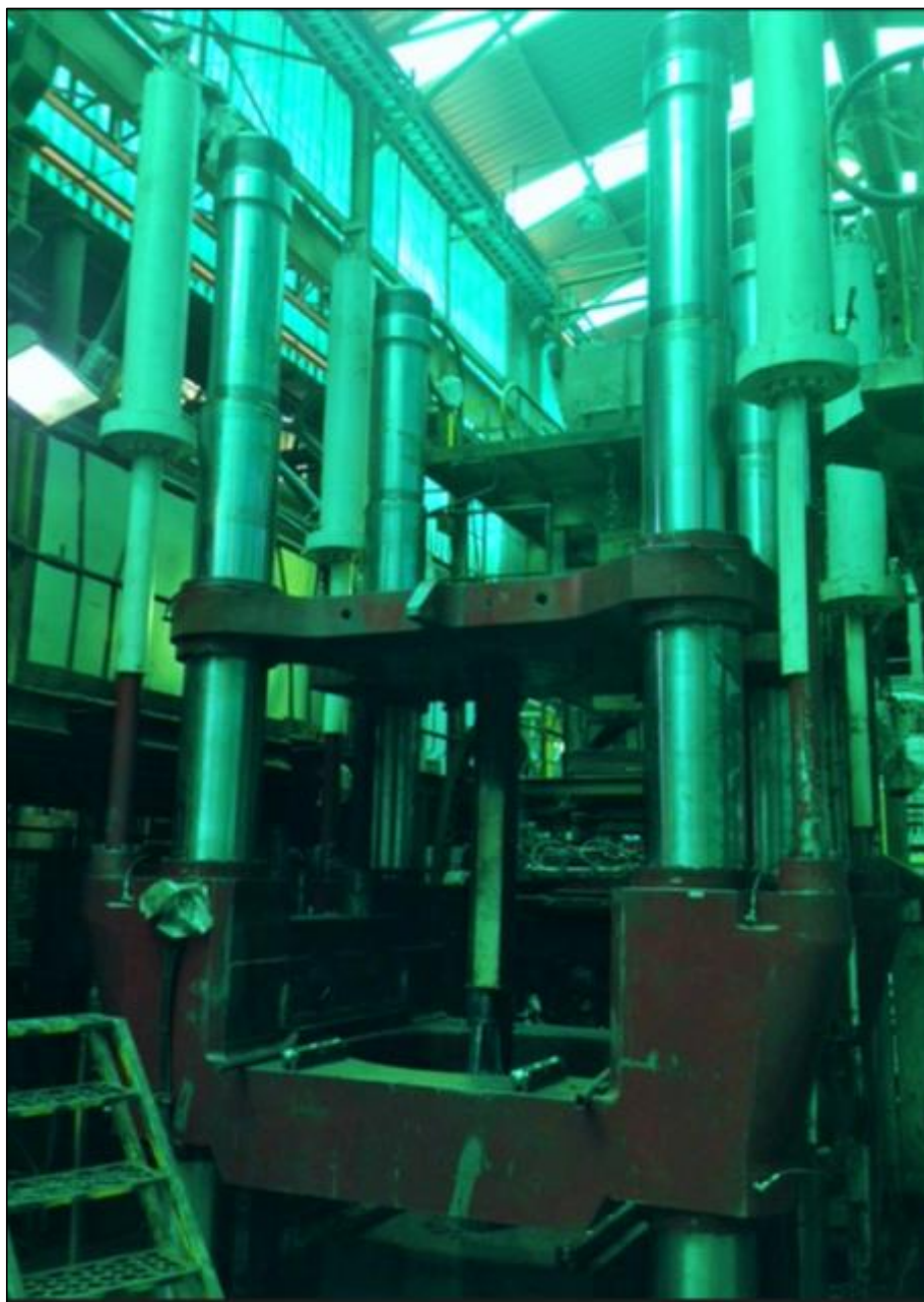
FIGURA 4.24 - Conjunto de quatro novas colunas montadas conforme estudos aqui apresentados.
