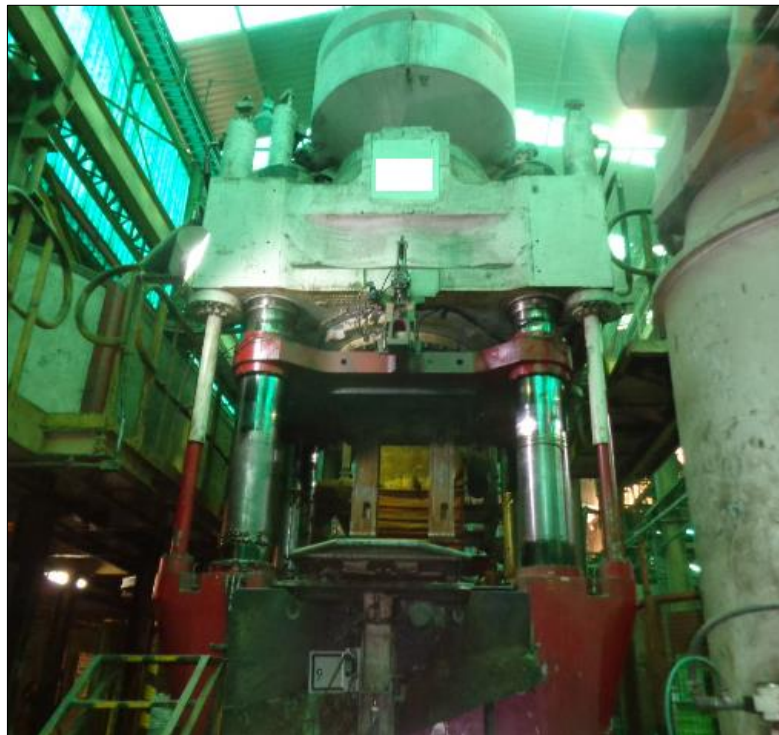
FIGURA 2.3 - Prensa hidráulica vertical avaliada de 25.000 kN, com suas quatro colunas estruturais.
