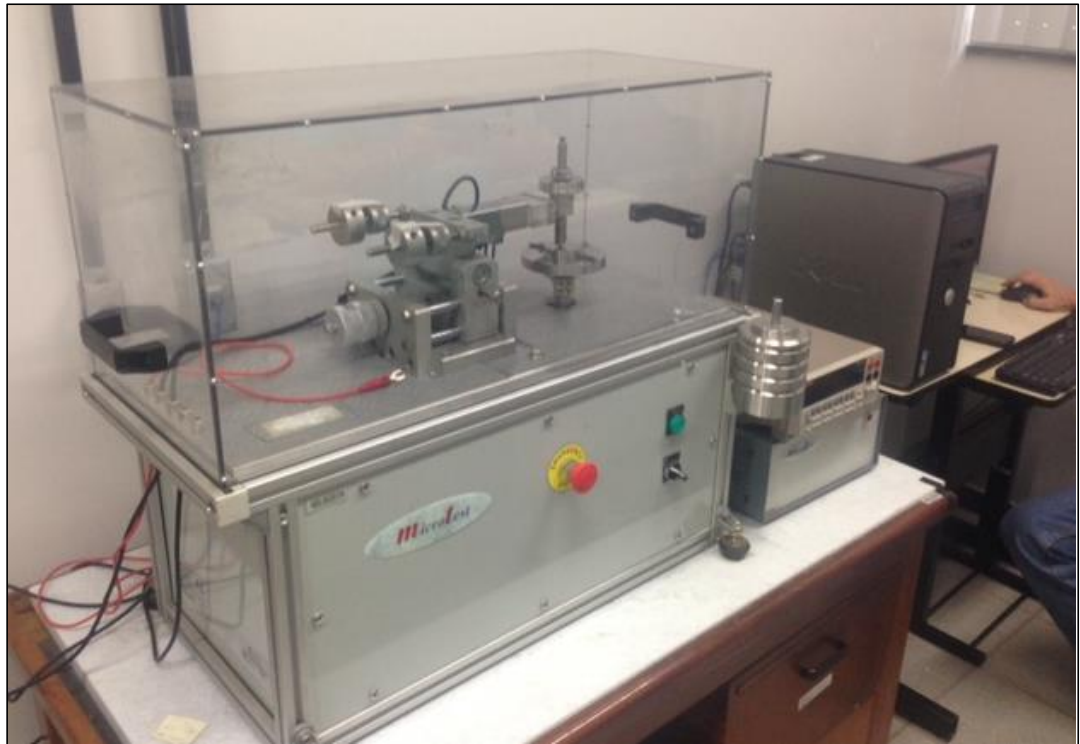
FIGURA 2.21 – Tribômetro do tipo “Pino sobre disco”. Fabricante Microtest.
