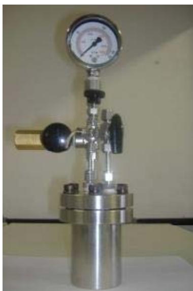
Figura 2.2 Autoclave utilizada nos testes catalíticos realizados a pressões superiores a 1 atm.
