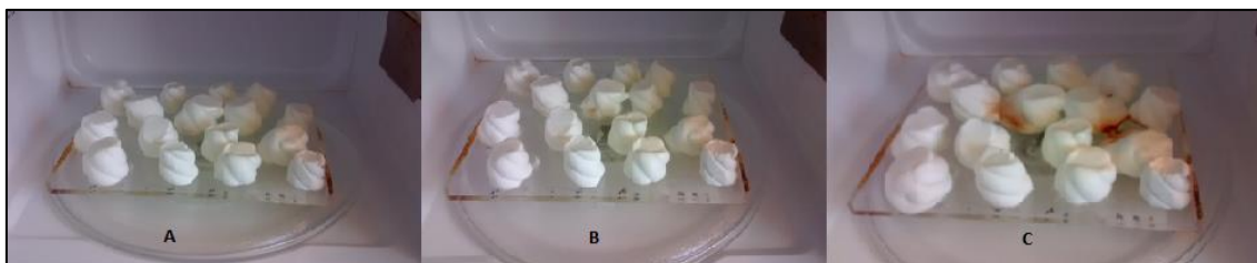
Figura 24 – Esquema dos marshmallows dentro do forno de micro-ondas: A) Antes da irradiação, B) após 30 segundos a potência máxima e C) após 2 minutos a potência máxima
