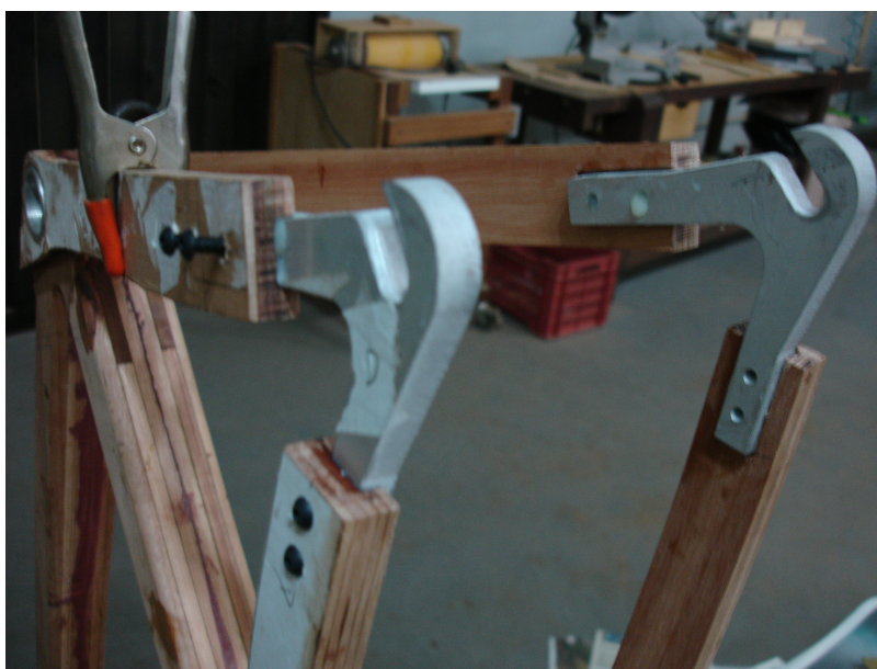
Figura 44: Gancheiras coladas e aparafusadas.
