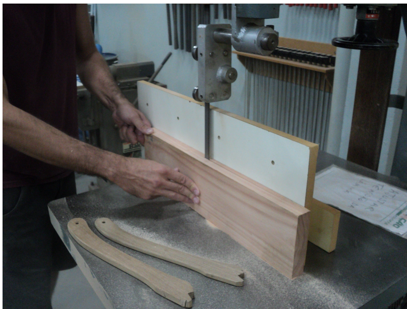
Figura 10: Corte das lâminas na serra de fita.
