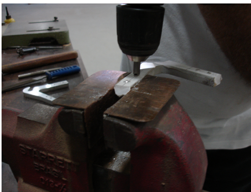
Figura 22: Chanfro de 45° nas bordas do furo da gancheira.
