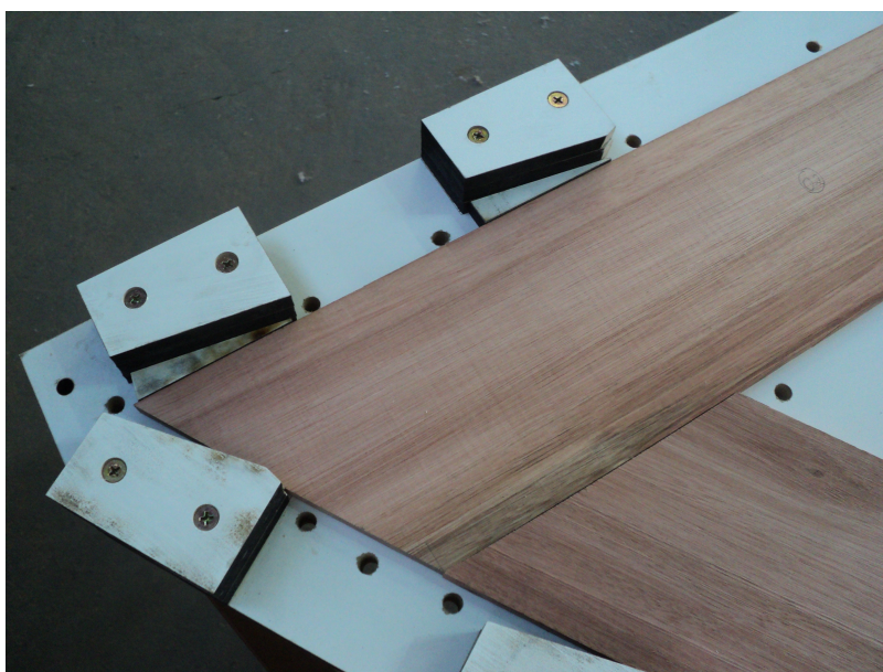
Figura 25: Cunhagem das peças no sentido transversal.
