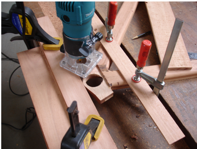
Figura 40: Rebaixo feito com tupa. A guia está presa com sargentos vermelhos.
