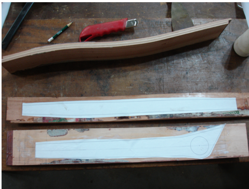
Figura 35: Desenho do perfil dos apoios colados sobre as lâmina.
