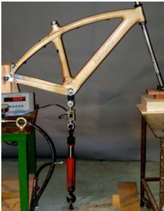
Figura 55: Ensaio com força aplicada no tubo do movimento central.
