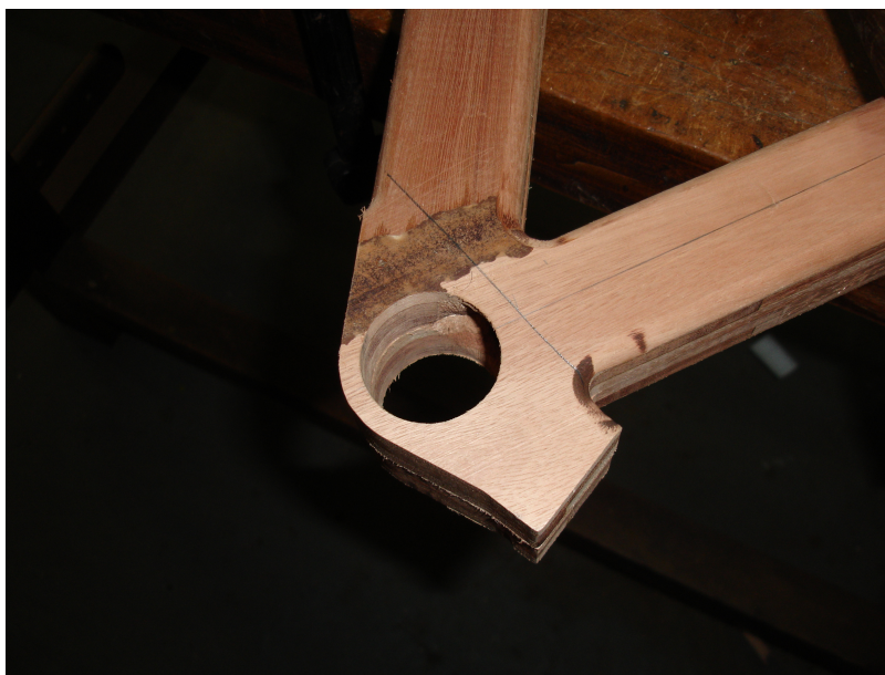
Figura 39: Marcação para rebaixo no triângulo principal.
