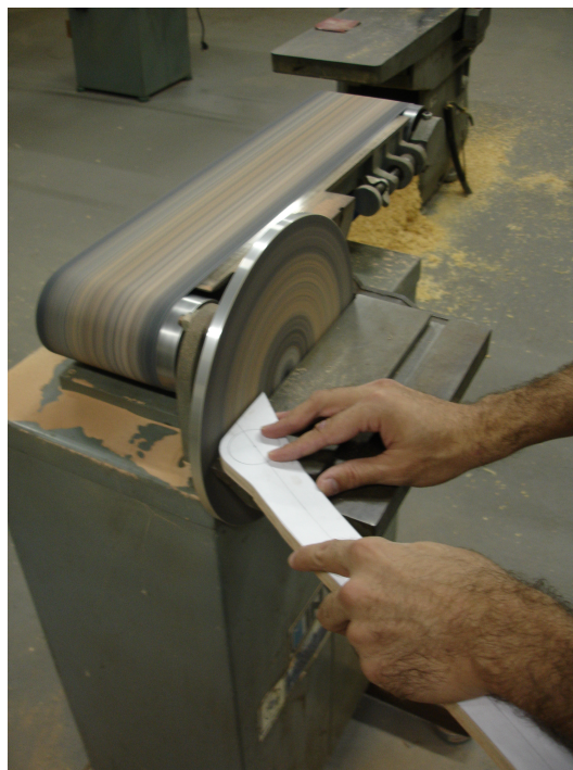
Figura 37: Finalização do perfil do apoio na lixadeira.
