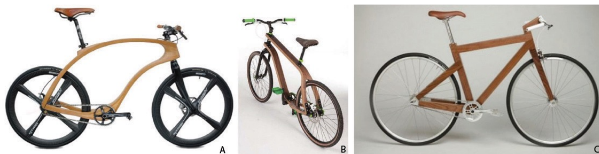
Figura 1: a) e b) Quadros com pouca rigidez estrutural; c) quadro com peças de perfil retangular.
