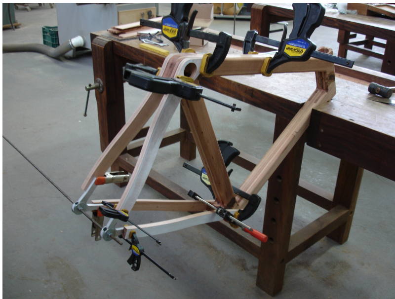
Figura 41: Pré-montagem para marcação do rebaixo no apoio para encaixe da gancheira.
