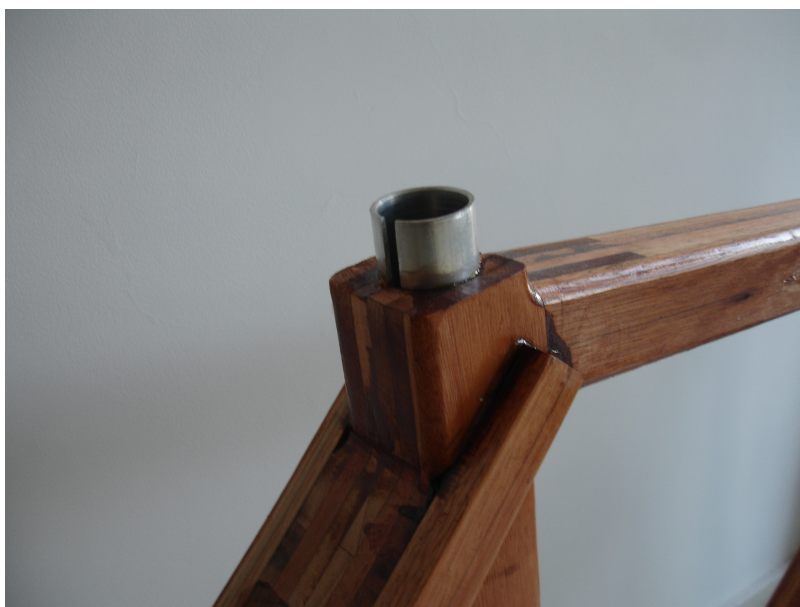
Figura 19: Tubo do selim com fenda para aperto da presilha.
