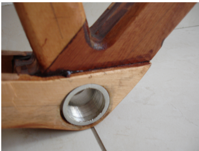
Figura 20: Tubo do movimento central com rosca interna.
