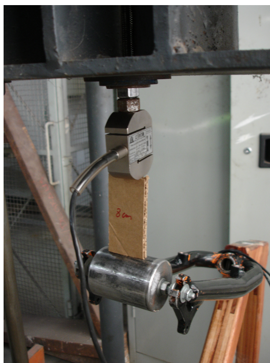
Figura 60: Célula de carga acoplada ao peso; garfo com rolete de aço; gabarito para medir distância de queda do peso.
