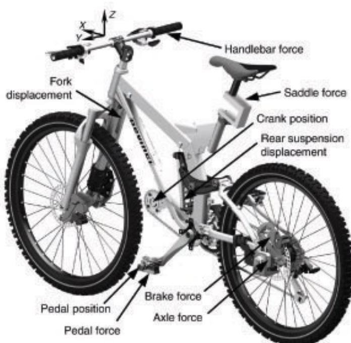
Figura 4: Bicicleta instrumentada com dinamômetros e sistema de aquisição de dados portátil.
