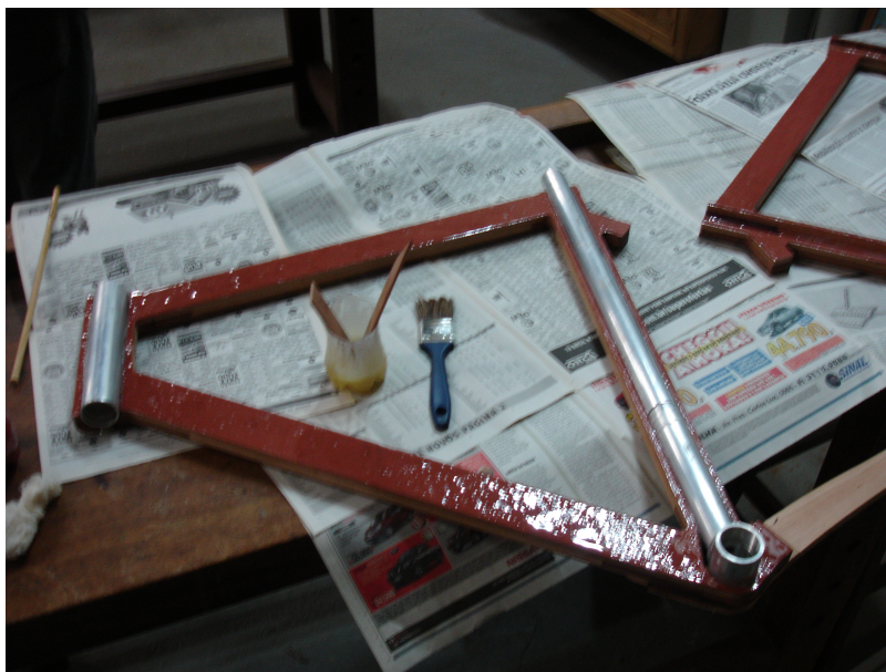
Figura 45: Colagem das duas metades do triângulo principal.
