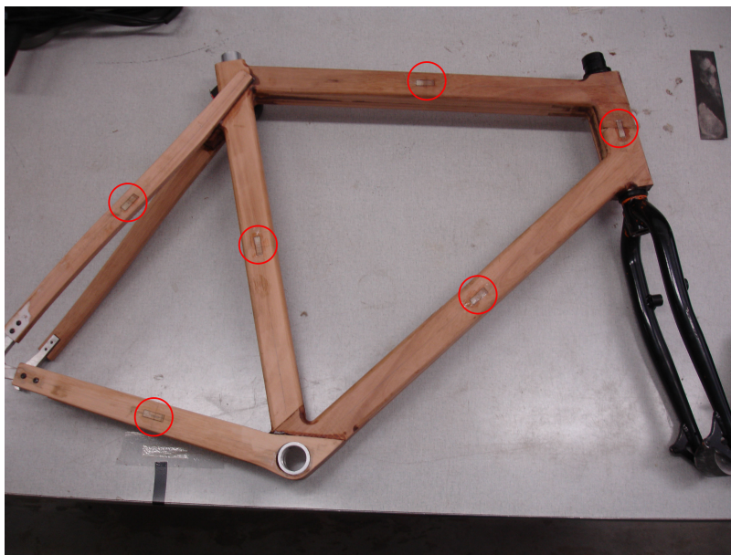
Figura 57: Extensômetros colados ao quadro - ainda sem a fiação.
