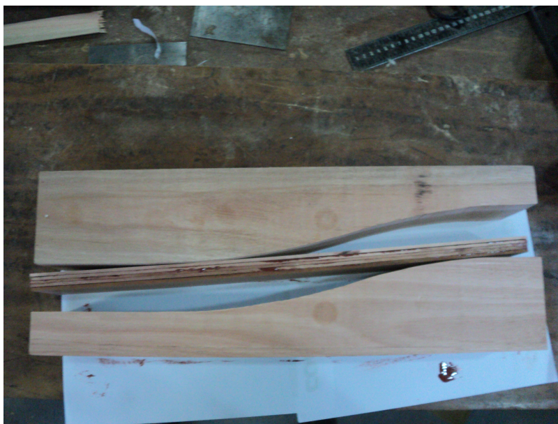
Figura 28: Lâminas dos apoios já com cola.
