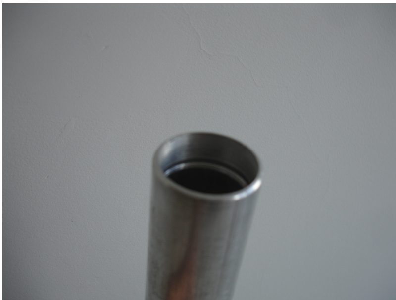
Figura 18: Tubo de direção com fresagem nas extremidades.
