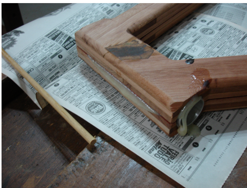
Figura 47: Vazamento do excesso do adesivo epoxi.
