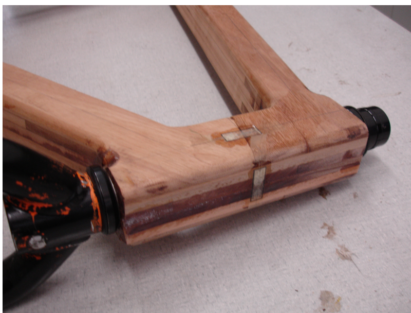
Figura 58: Extensômetro na frente do tubo de direção na direção transversal.
