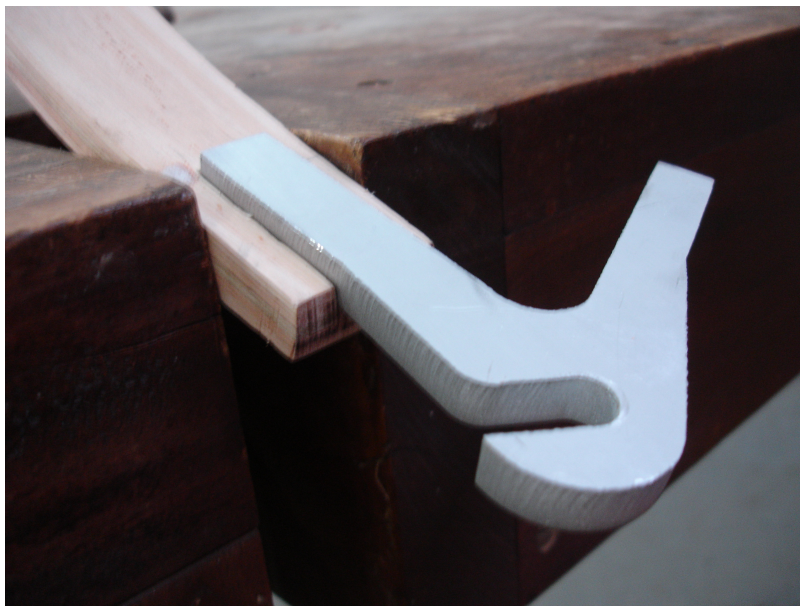
Figura 43: Gancheira encaixada no apoio (ainda sem os furos dos parafusos).
