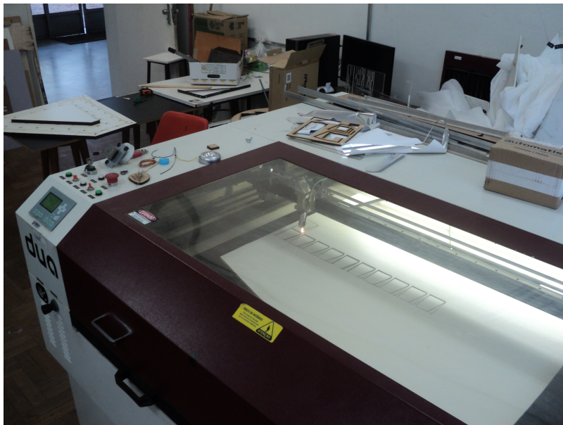
Figura 13: CNC a laser utilizada para corte da prensa e dos gabaritos
