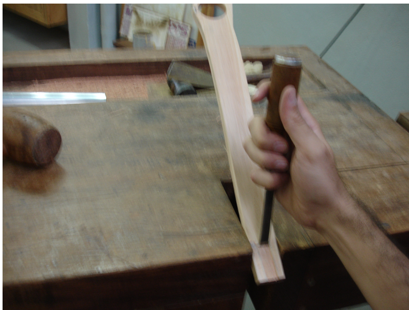
Figura 42: Rebaixo feito com formão para encaixe da gancheira.
