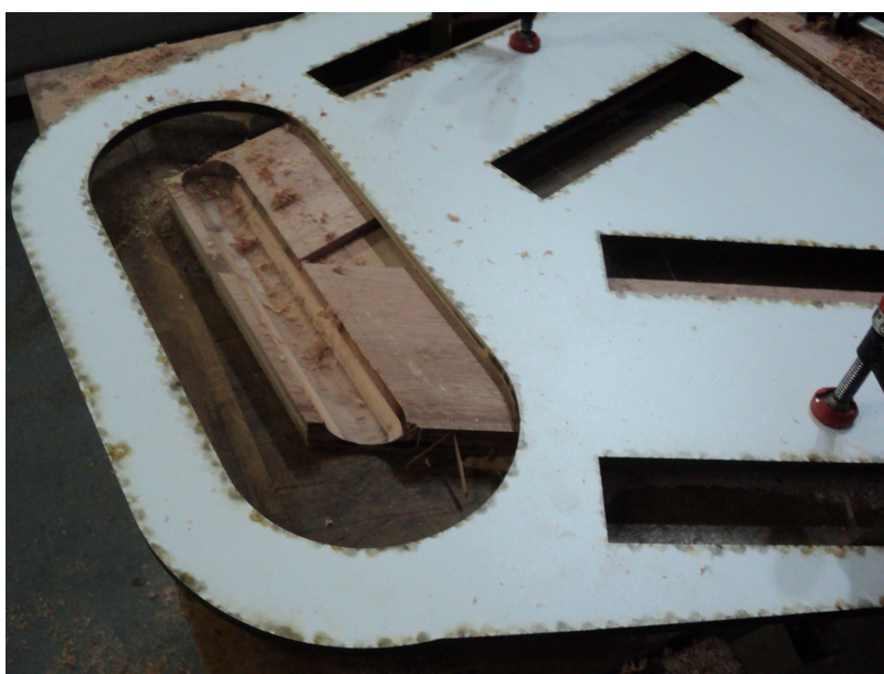
Figura 32: Detalhe final do corte do sulco.
