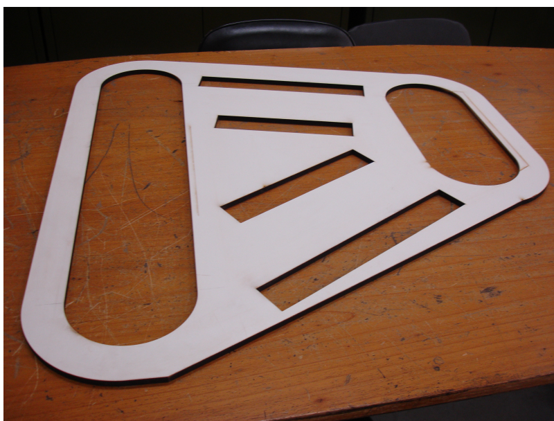
Figura 16: Gabarito para corte dos sulcos.
