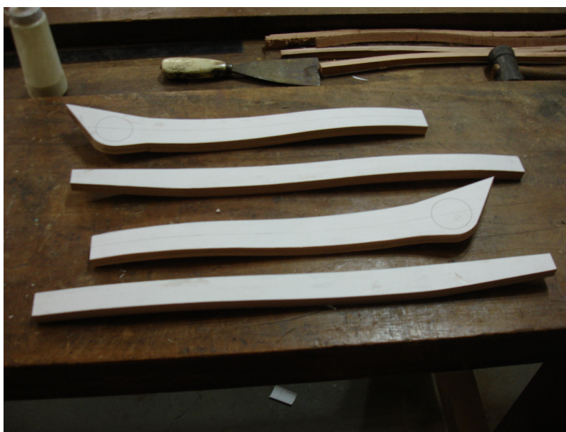
Figura 38: Apoios com perfil finalizados.
