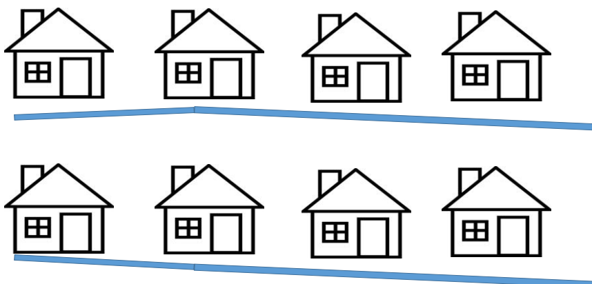
Figura 26 - Inclinação rua Pará após primeira e segunda passada da máquina
