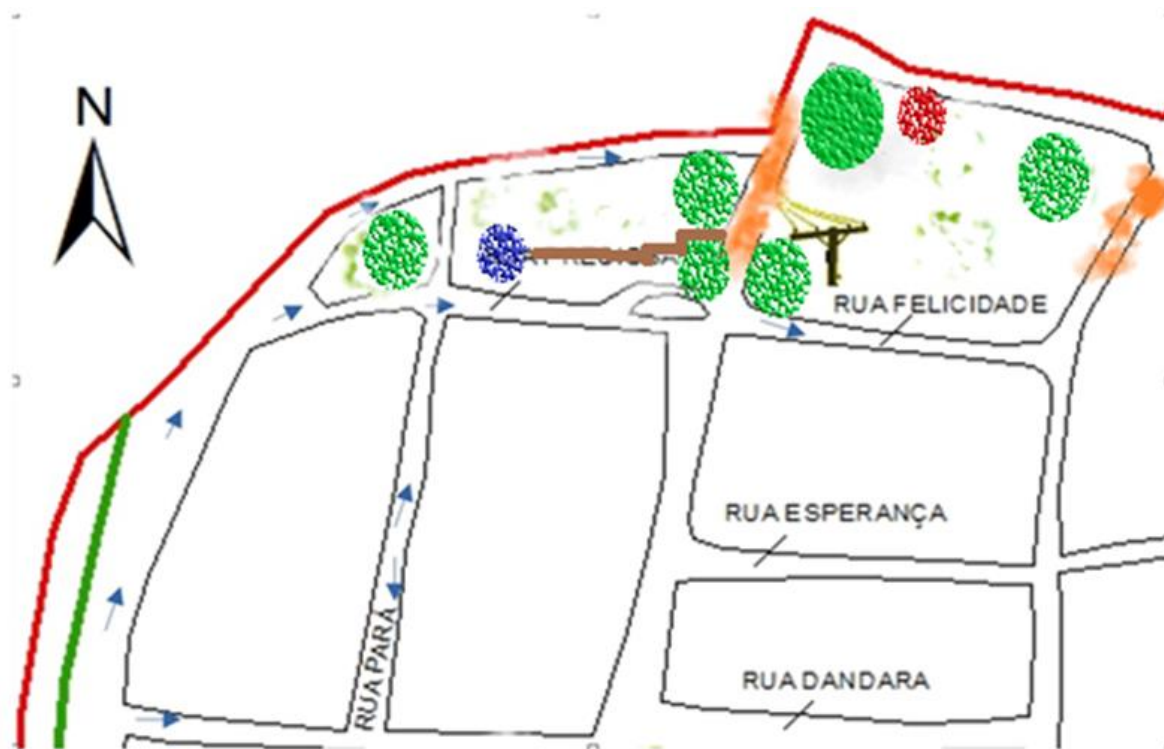
Figura 17 - Localização das hortas, wetland , caixa de gordura, acúmulo de lama e caminho de água cinza.
