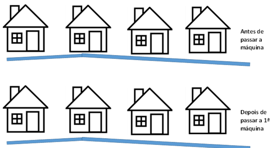
Figura 24 - Traçado rua Pará antes e após primeira terraplanagem.
