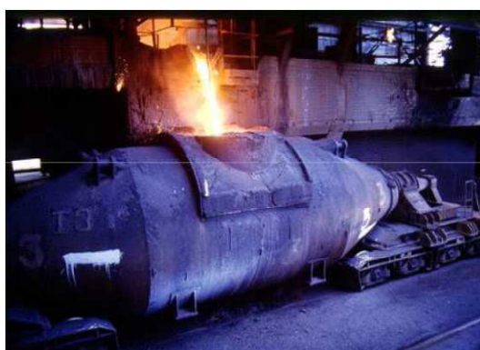
Figura 3.11 – Carro Torpedo e revestimento em fibra de backup.
