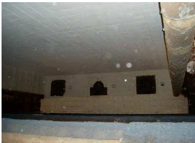
Figura 3.18 - Fibras como revestimento de trabalho em fornos de tratamento térmico.
