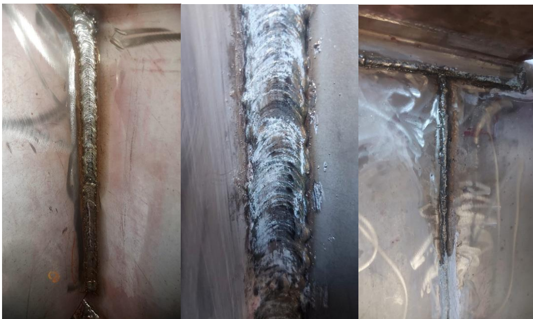
Figura 31 – ensaio EVS após soldagem
