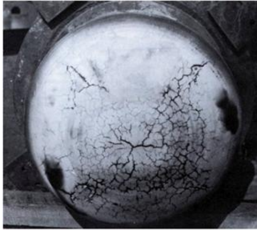
Figura 16 - Corrosão sob tensão em uma autoclave de aço 304. Fonte: Apostila Acesita
