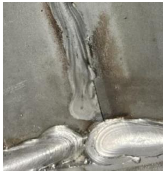
Figura 28 - Descontinuidade do cordão de solda
