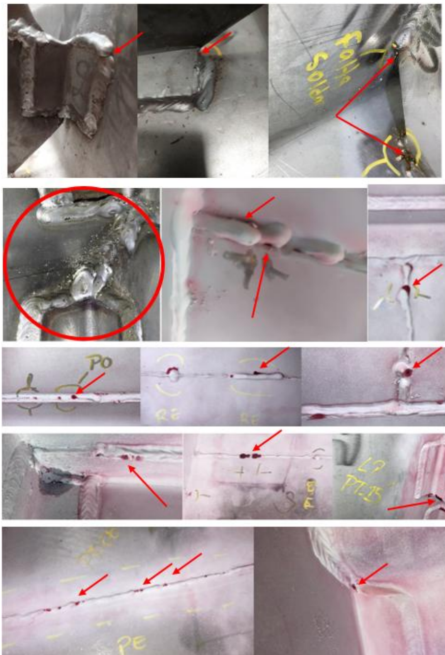
Figura 30 – diversas imagens com soldas contendo frestas
