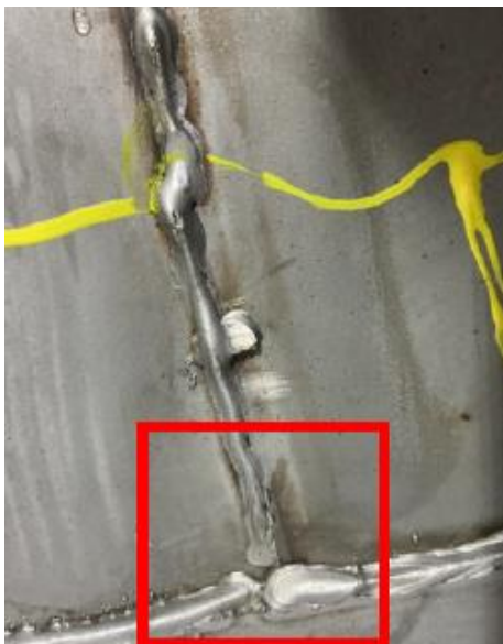
Figura 28 - Descontinuidade do cordão de solda
