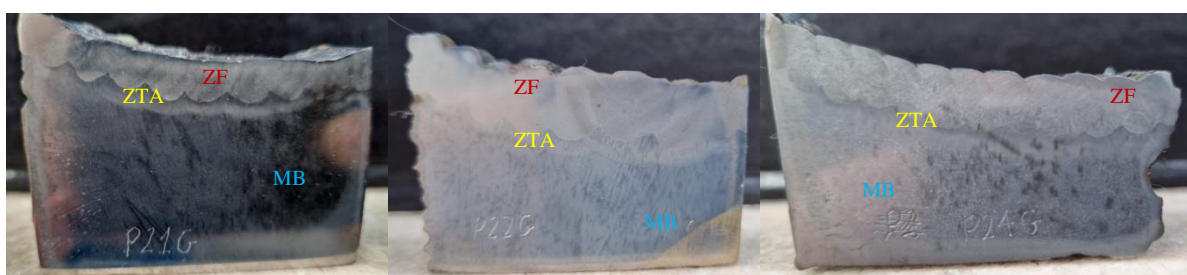
Figura 10. – Macroestruturas das posições 1G, 2G e 4G da amostra P2 (GMAW, Pré-usinagem).
