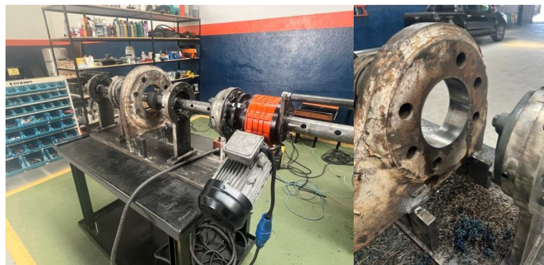
Figura 4. Processo de limpeza com pré-usinagem (Mandrilhadora Portátil)
