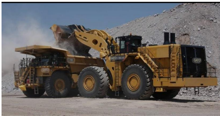
Figura 13. Carregadeira CAT994K em operação.
