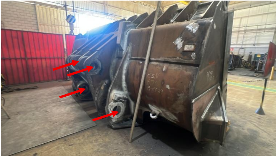
Figura 2 - Processo de reforma dos furos da caçamba Cat994
