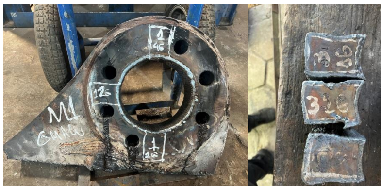
Figura 7. Mancal - Amostras (P) e Posições (1G, 2G e 4G)
