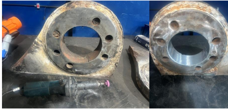
Figura 3. Processo de limpeza mecânica manual (Retifica com ponta manual)
