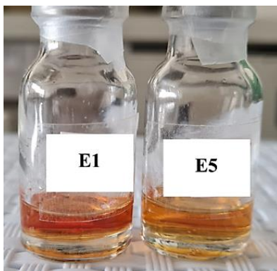
Figura 32 - Imagem representativa das formulações E1 versus E5 após 45 dias do preparo quando já se nota diferenciação de coloração entre elas
