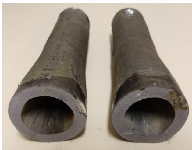
Figura 5-2: Pontas fraturadas durante trefilação do aço SAE 52100 a partir do estado laminado.
