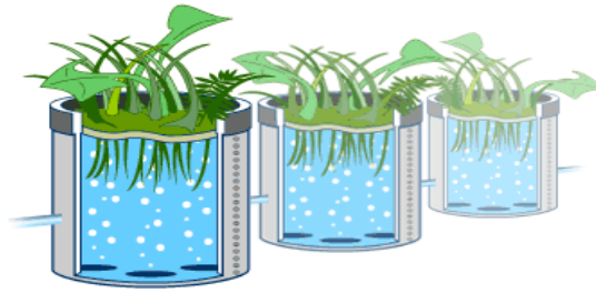
Figura 3 – Sistema de Reciclagem Composto de Filtros Mistos e Plantas Aquáticas
