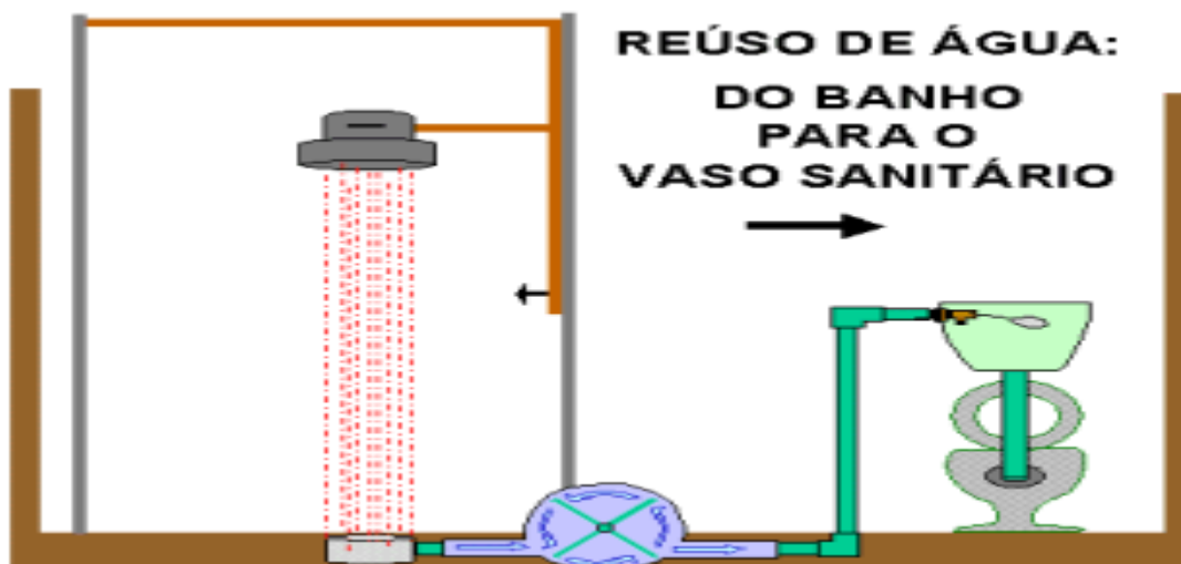
Figura 2 - Esquema de reuso água em banheiros Fonte: www.eca.usp.br
