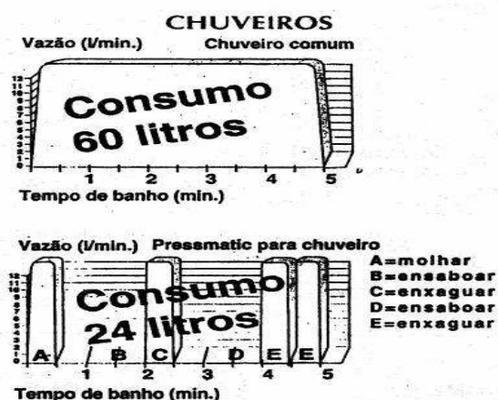
Figura 16 – Comparação entre chuveiros comum e por acionamento hidromecânico Fonte: COELHO, 2001, p. 128
