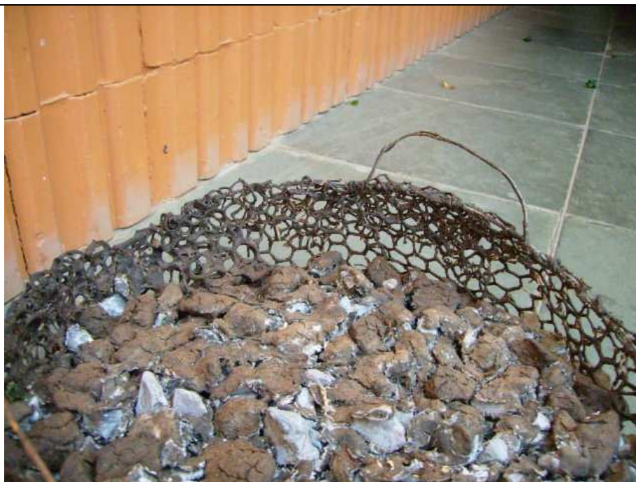
Figura 49 - Características do cesto e material drenante (brita 01), um mês após a desmontagem do sistema.
