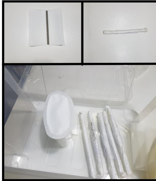
Figura 23 – Armazenamento das barras livres de umidade.
