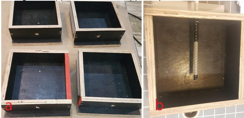
Figura 25 – (a) Fôrmas de madeira (b) Barra posicionada na fôrma.
