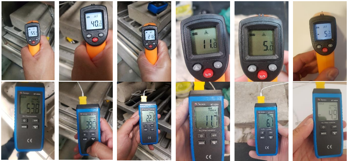
Figura 52 – Aferição de temperaturas: imagens do topo indicam as medidas do termômetro de superfície e as imagens inferiores indicam as medidas do termopar no interior.
