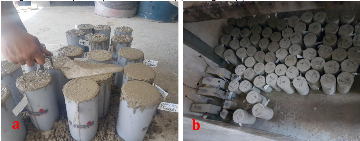
Figura 19 - Corpos de prova cilíndricos: (a) Moldagem, (b) Cura em câmara úmida.
