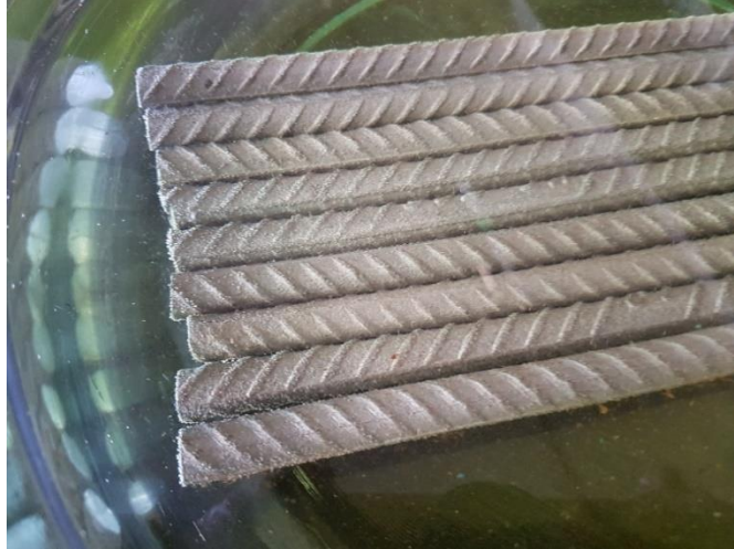
Figura 22 - Redução de hidrônio no processo de limpeza das barras.
