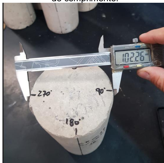
Figura 40 - Aferição dimensões corpo de prova cilíndrico de 0,10m de diâmetro e 0,20m de comprimento.
