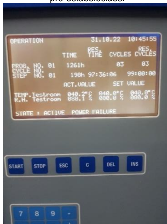
Figura 49 - Tela de comando câmara apresentando valores de temperatura e umidade pré-estabelecidos.
