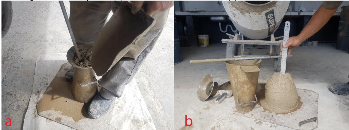
Figura 29 - Slump test: (a) Preenchimento do molde, (b) Medida do abatimento.
