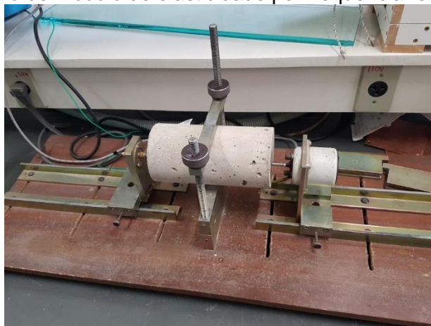
Figura 34 - Ensaio de módulo de elasticidade por frequência ressonante forçada.
