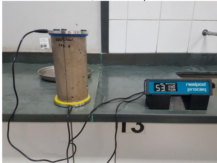
Figura 39 - Aferição resistividade elétrica volumétrica do corpo de prova de 0,10m de diâmetro e 0,20m de comprimento.
