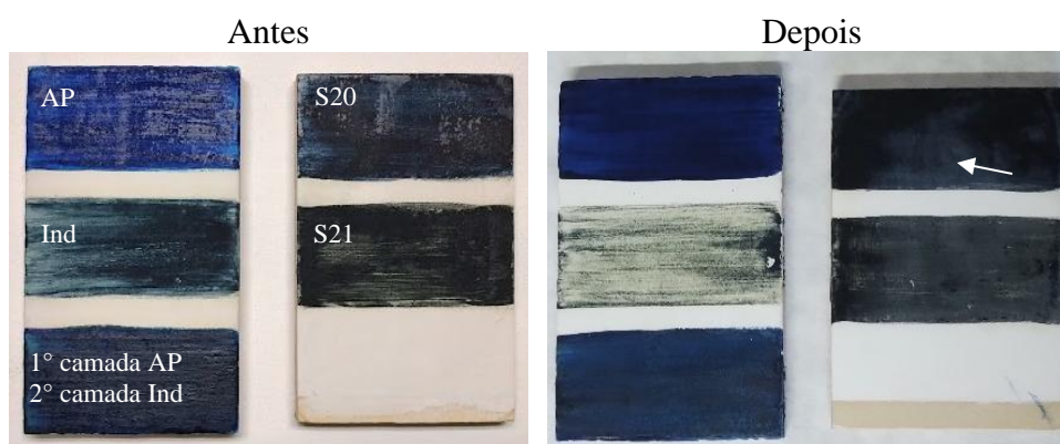
Figura 53. Protótipos de óleo sobre madeira com adição de \text{CaCO}_3 antes e depois do teste de envelhecimento acelerado.
