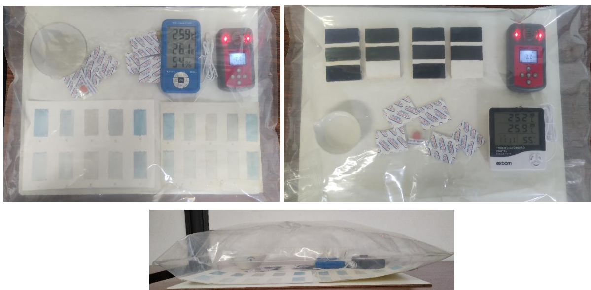
Figura 40. Experimento de anóxia dos protótipos de aquarela sobre papel e de óleo sobre madeira.
