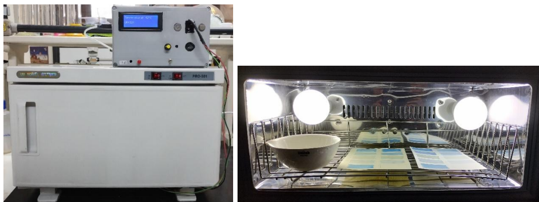
Figura 41. Câmara montada para teste de envelhecimento acelerado.
