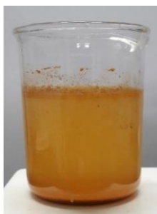
Figura 34. Sobrenadante oxidado da mistura entre a lixívia da calcinação e a solução de sulfatos.
