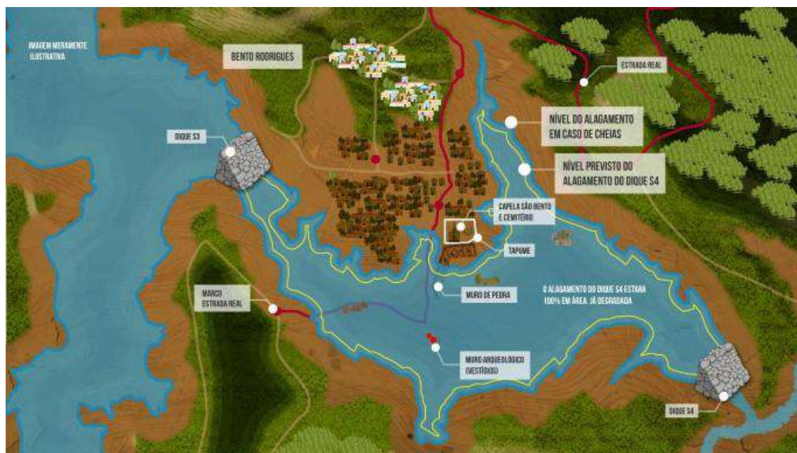
Figura 02: ilustração das inundações pelos diques de contenção
