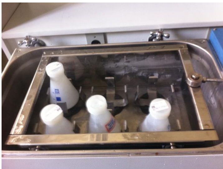
Figura 4.8 – Ensaio Chapelle etapa do banho-maria com amostra de resíduos e amostra em branco.
