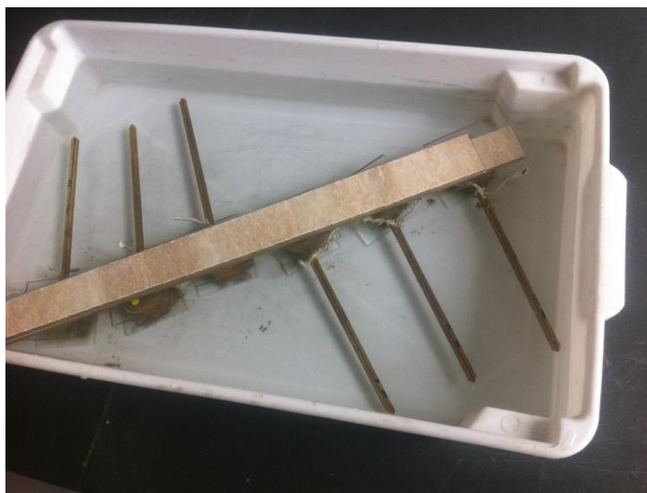
Figura 4.9 – Ensaio expansibilidade com a pasta de resíduo dentro da agulha Le Chatelier coberta com placas de vidro e submersa em água.
