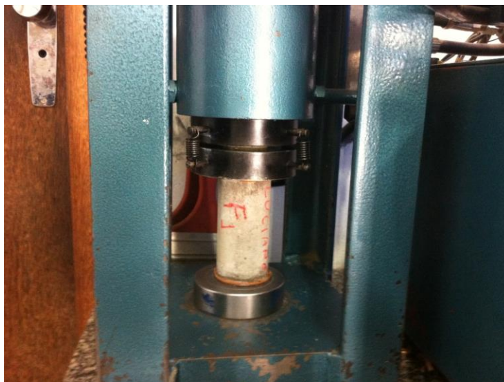
Figura 4.16 – Ensaio de compressão Prensa Pavitec.
