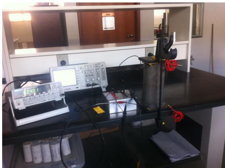
Figura 4.15 – Equipamento ensaio de resistividade elétrica.
