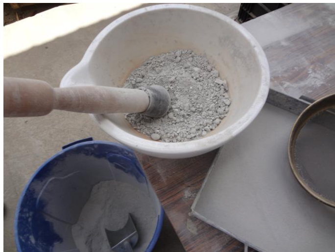
Figura 4.6 – Destorroamento do resíduo.
