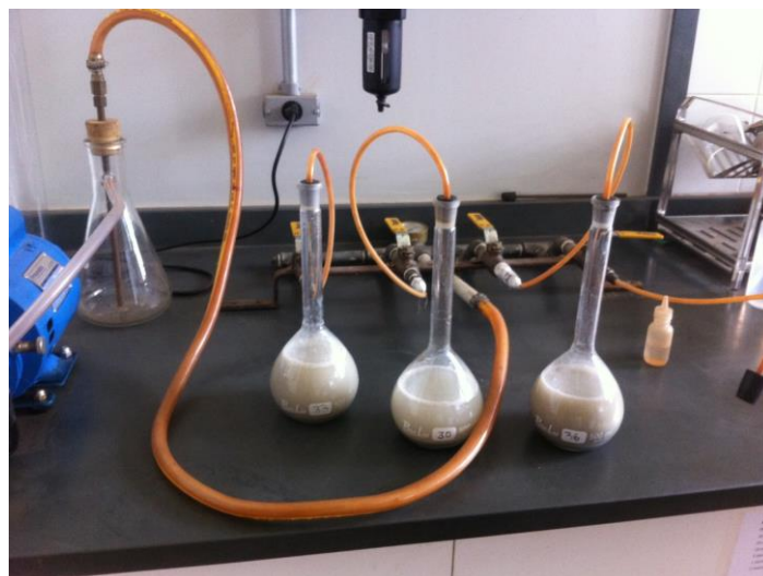
Figura 4.7 – Técnica do picnômetro por meio de bomba a vácuo.
