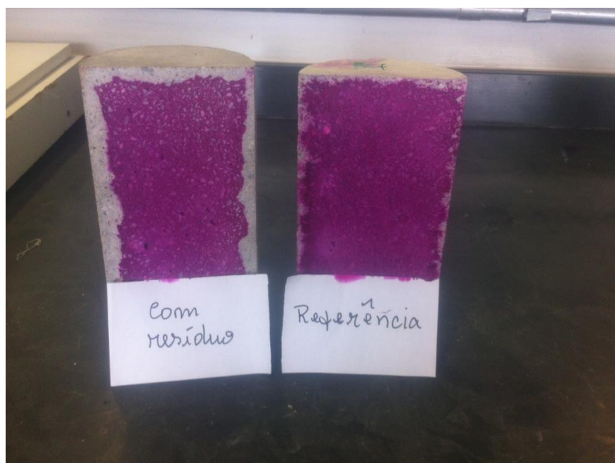
Figura 5.21 – Resultado de amostra com e sem resíduos com propagação da frente de carbonatação.
