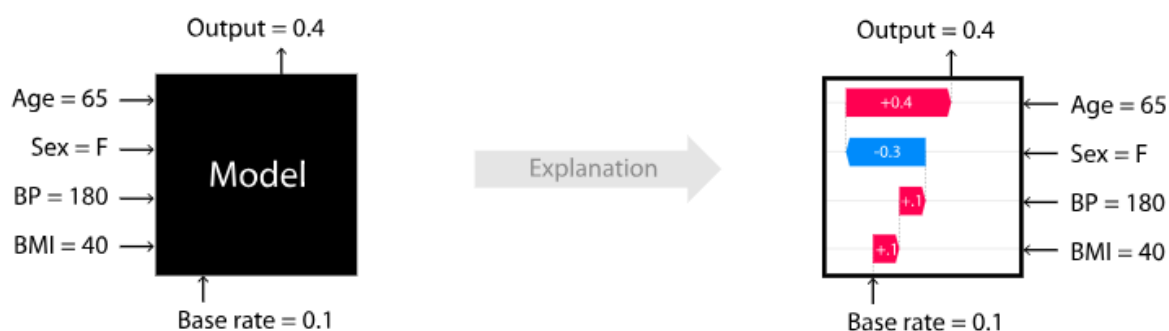
Figura 2.4: Exemplo simples de como SHAP ajuda na interpretação da predição de modelos.
