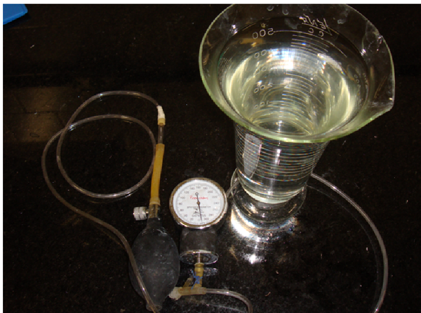
Figura 3 – Sistema para medida da pressão de ruptura
