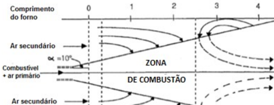
Figura 11: Injeção de ar primário e secundário no queimador principal.
