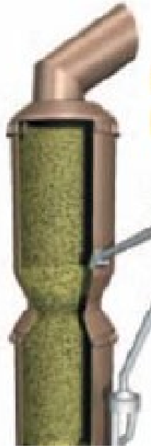
Figura 27- Esquema enfatizando o sistema de ar e combustível sequenciados.
