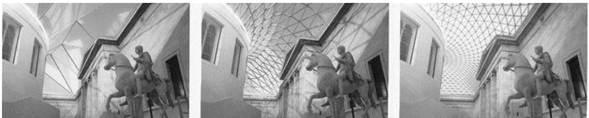
Figura 2.14 - Simulações computacionais de subdivisão da cobertura
