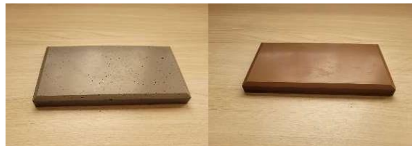
Figura 3 – Placas de geopolímeros, respectivamente, TT40 e TC30
