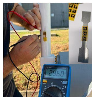
Figura 4. Sensor de monitoramento estrutural.
