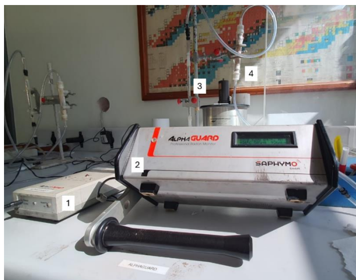
Figura 18 – Circuito de exalação
