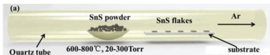
Figura 15. Esquema representativo do sistema de deposição na fase vapor de SnS. Imagem reproduzida de [65].
