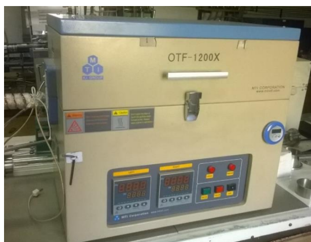
Figura 18. Foto do forno tubular (OTF – 1200X) utilizado para síntese das amostras.
