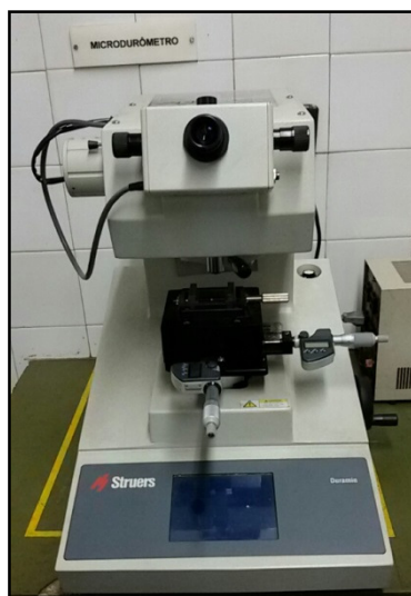
Figura 4.3- Microdurômetro da marca Struers utilizado para a medição de dureza da fase ferrítica.
