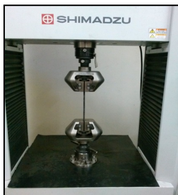
Figura 4.4- Máquina para ensaio de tração da marca Shimadzu.
