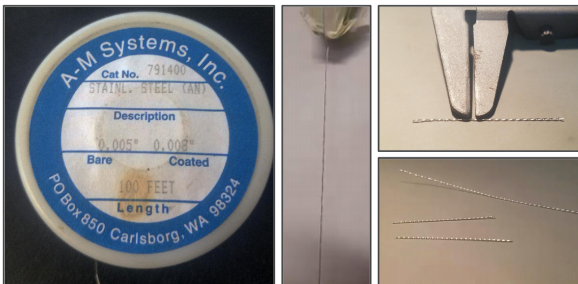
Figura 10: Material utilizado e detalhes da confecção do eletrodos de estímulo. Esquerda: Modelo de fio de aço inoxidável. Centro: Fio dobrado ao meio e tracionado para trançar. Direita: Resultado final distâncias de 0,5mm entre os nós.
