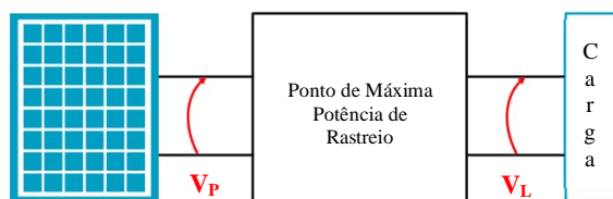
Figura 3-12 - Módulo fotovoltaico conectado à carga com destaque para função MPPT do inversor
