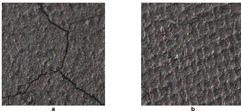
Figura 5.25 Micrografia óptica dos filmes de LSCF depositados por serigrafia sobre suporte de ZEI (a) e suporte de CGO (b).
