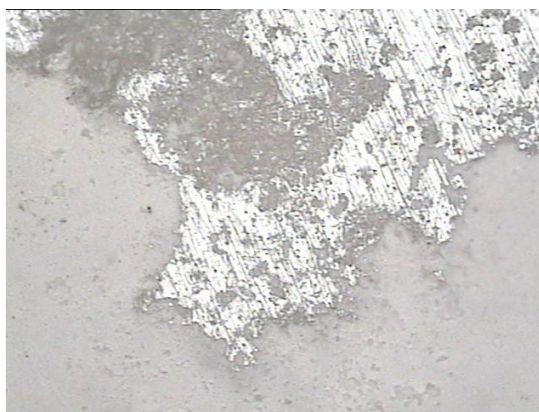
Figura 5.21 Micrografia óptica de um filme de CGO depositado sobre pastilha de ZEI – Aumento de 100X.
