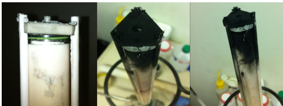
Figura 5.52 Célula completa montada em célula NorECs de medidas, antes e após o teste com reforma interna de etanol.
