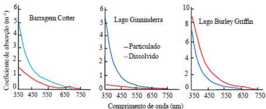
Figura 4: Propriedades de absorção espectral com diferentes concentrações de NAP e substâncias dissolvidas em águas interiores australianas. Barbosa et al (2019).
