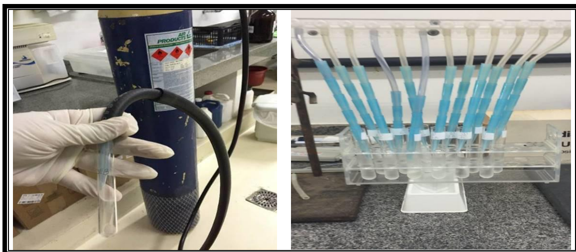
Figura 10 – Processo de evaporação de amostras de plasma após processo de extração. Evaporação manual unitária e com a utilização de equipamento adaptado. Fonte: Arquivo pessoal.
