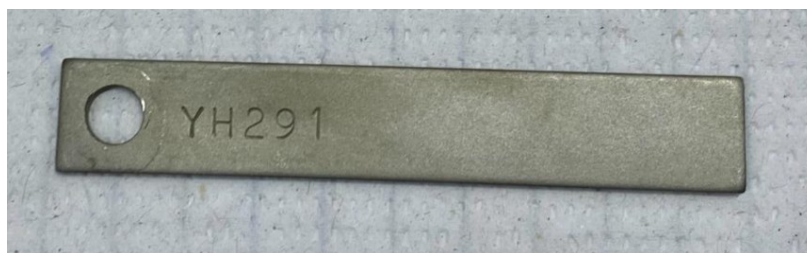
Figura 14 – Corpo de prova em aço carbono AISI 1020 para o ensaio de imersão total e taxa de corrosão.
