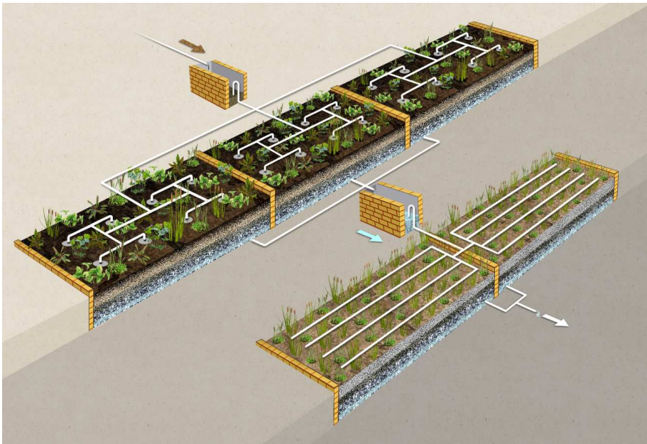
Figura 5.1 – Esquema de um wetland vertical – Sistema Francês tradicional: três unidades no primeiro estágio e duas unidades no segundo estágio.
